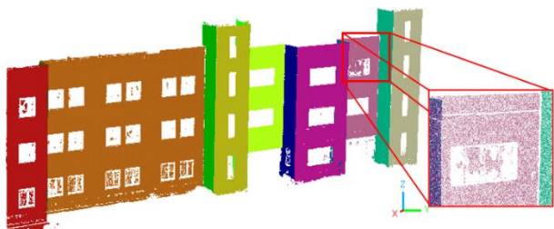
شکل ۱۲: نتایج مرحله دوم الگوریتم برای ابرنقطه تصویربرداری پهپاد (کادر قرمز): نمونه‌ای از عدم توانایی تولید نقطه الگوریتم SfM از محیط داخل پنجره‌ها (شیشه) در تصاویر که به اشتباه به عنوان دیوار در نتایج الگوریتم پیشنهادی استخراج شده‌اند Fig. 12: The results of the second stage of the algorithm for the UAV imaging point cloud (red box): an example of the inability of the SfM algorithm to generate points from the environment inside the windows (glass) in the images that are mistakenly extracted as walls in the results of the proposed algorithm
