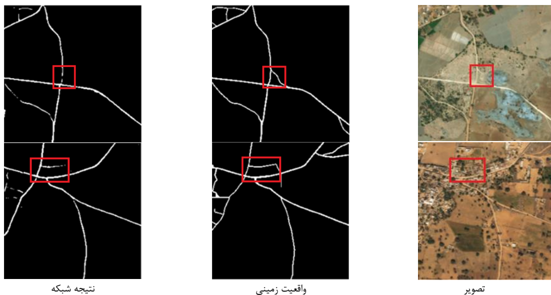
شکل ۵: نتایج تشخیص جاده‌های فرعی در شبکه بهبودیافته پیشنهادی UNet3+ Fig. 5: Secondary roads detection results in proposed modified UNet3+ model
