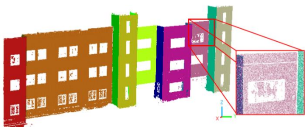
شکل ۱۲: نتایج مرحله دوم الگوریتم برای ابرنقطه تصویربرداری پهپاد (کادر قرمز): نمونه‌ای از عدم توانایی تولید نقطه الگوریتم SfM از محیط داخل پنجره‌ها (شیشه) در تصاویر که به اشتباه به عنوان دیوار در نتایج الگوریتم پیشنهادی استخراج شده‌اند Fig. 12: The results of the second stage of the algorithm for the UAV imaging point cloud (red box): an example of the inability of the SfM algorithm to generate points from the environment inside the windows (glass) in the images that are mistakenly extracted as walls in the results of the proposed algorithm
