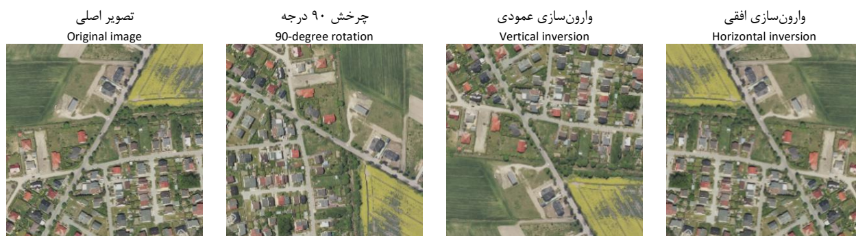
شکل ۲: نمایی از افزون‌سازی داده (تکنیک چرخش و وارونه‌سازی) Fig. 2: A view of data augmentation (rotation and flipping technique)
