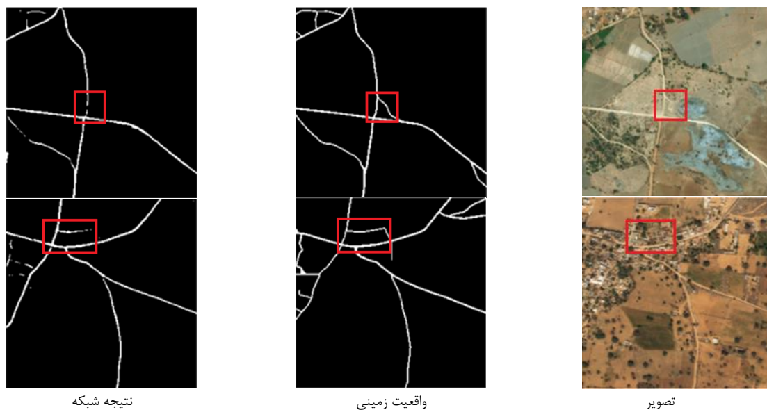
شکل ۵: نتایج تشخیص جاده‌های فرعی در شبکه بهبودیافته پیشنهادی UNet3+ Fig. 5: Secondary roads detection results in proposed modified UNet3+ model
