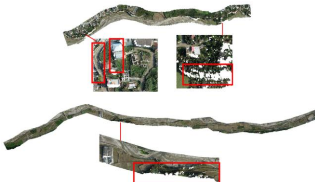
شکل ۱۴: ابر نقطه ای تولید شده در Agisoft Metashape Fig. 14: Point cloud generated in Agisoft Metashape
