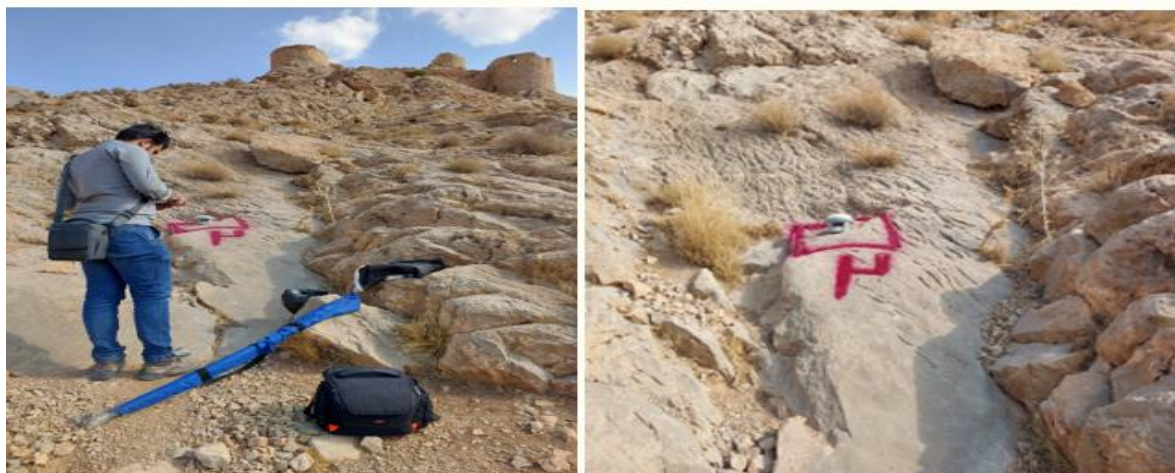
شکل ۳: اندازه‌گیری و ثبت نقاط کنترل زمینی تعیین‌شده در اطراف قلعه با استفاده از گیرنده تعیین موقعیت. Fig. 3: Measurement and recording of ground control points (GCPs) around the castle using a positioning receiver
